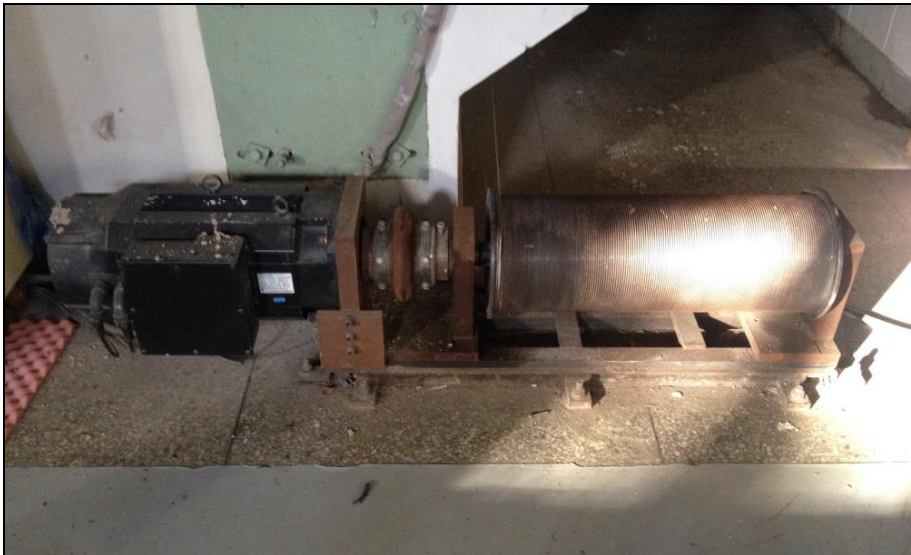
그림 1-3. 고속예인전차의 모터와 구동 드럼
