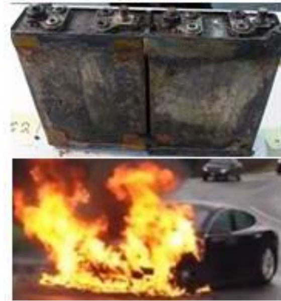
그림 1.4 리튬 이온 배터리의 열 폭주로 인한 폭발
