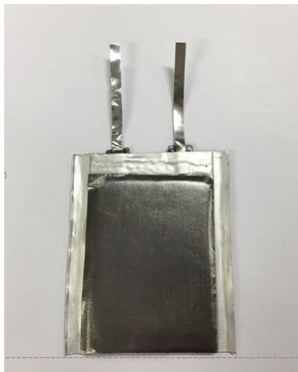
그림 3.4 그래파이트 시트를 부착한 리튬 이온 배터리
