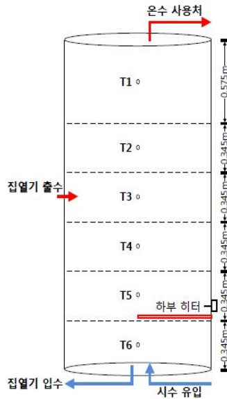
[그림 5.4] TRNSYS 시뮬레이션에 이용된 기존 보조열원 내장형 축열조의 모델링
