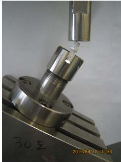
<[그림 1] 파절강도의 측정을 위해 임플란트를 30° 각도로 위치시킨 모습>
