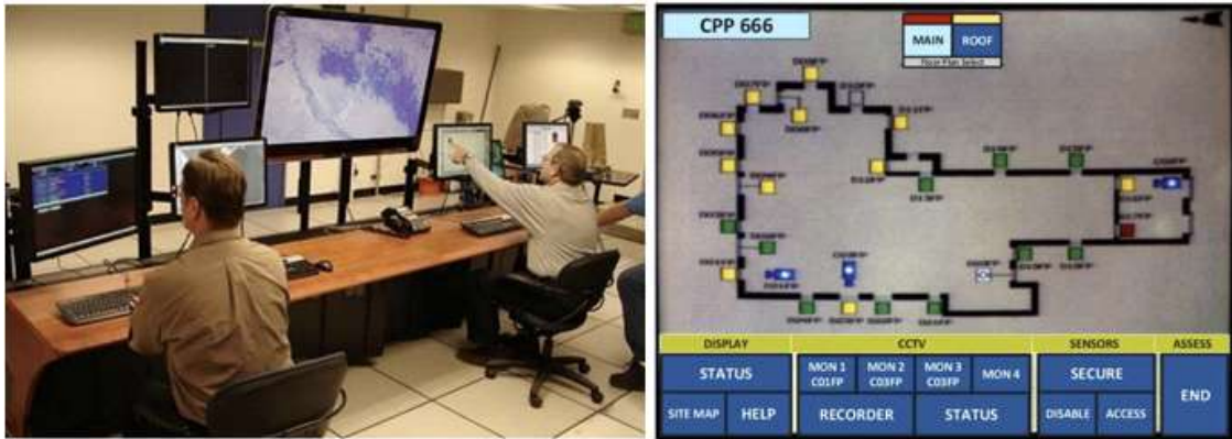
그림 2-8. 침입 탐지를 확인하는 중앙통제실과 침입지점 확인 화면 예시 (IAEA Nuclear Security Series No. 40-T)
