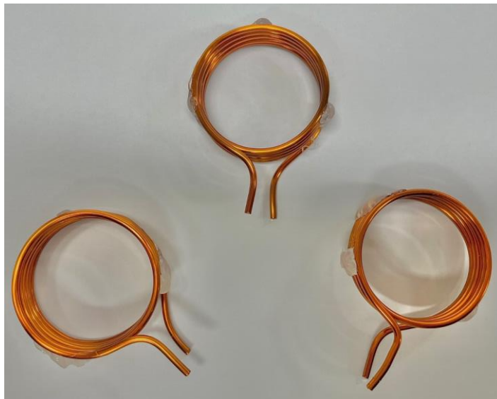
그림 3.30 동일 인덕턴스를 목표로 제작한 세 개의 공심 인덕터
