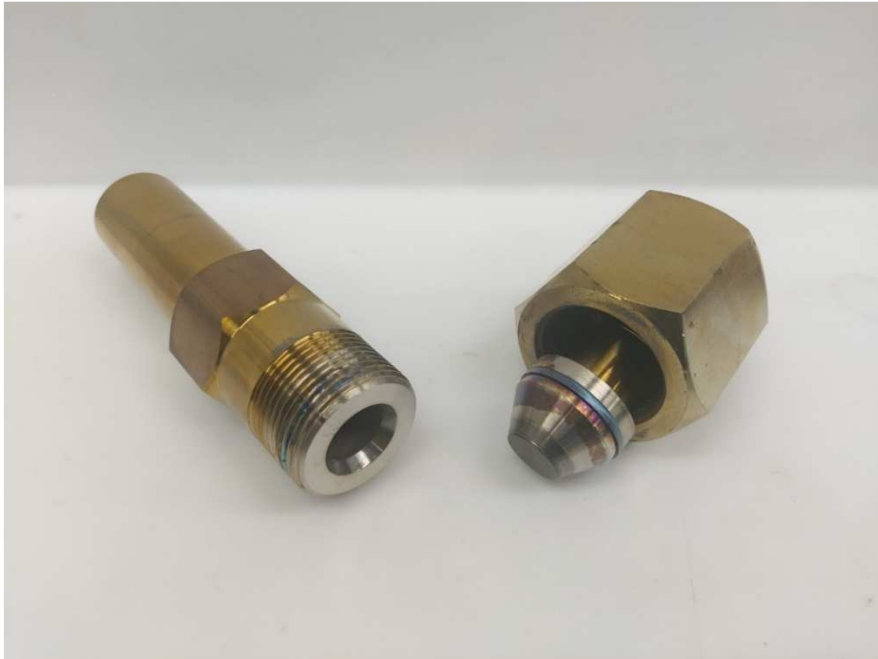
그림 2-4. 316 형 스테인리스강 23 ml 회분식 반응기
