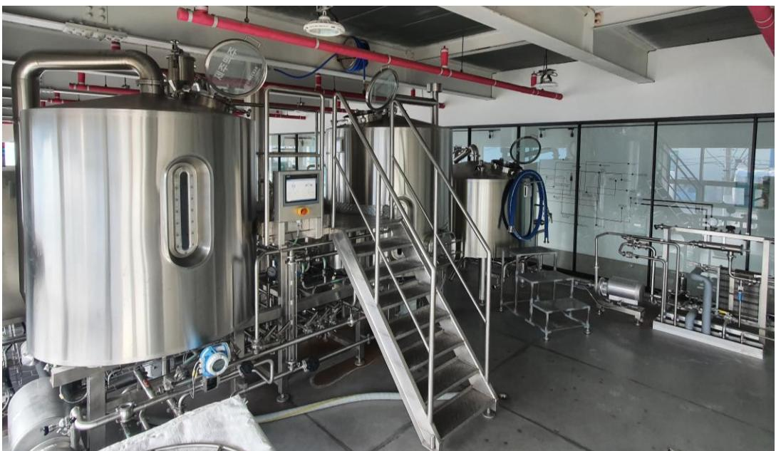
위 설비는 탱크의 위치와 규격만 다를 뿐, 제조 공정 이후 최종 제품 생산까지 본 설비 생산 설비와 동일한 라인과 설비를 사용하기 때문에 공정 적용 전 먼저 이상 유무를 확인할 수 있도록 설계되어 있다. 제 3장 1절에서 설명한바와 같이 미생물 교차 오염을 방지하기 위해 Kettle Souring 방식을 채택하였다.
