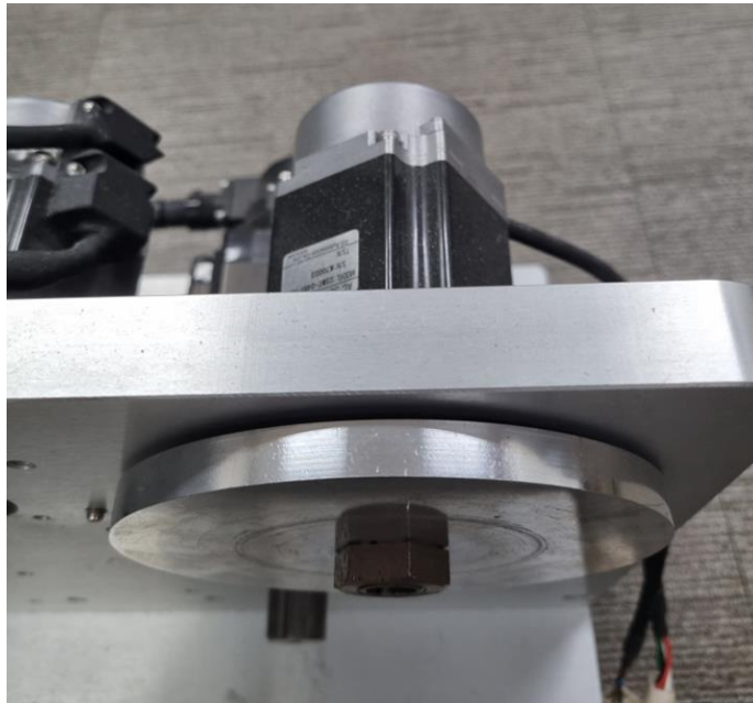
그림 2.8 산업용 원판 부하 시스템 구성
