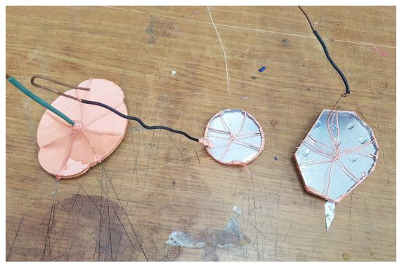
[그림 48] 전해주조를 활용한 프레임 제작과정
