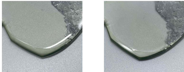
[그림 127] 시계 스크래치 연마제를 이용한 표면정리
