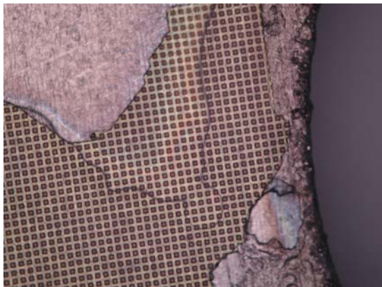
그림 5. Grid 샘플 blister 테스트 후 터진 모습
