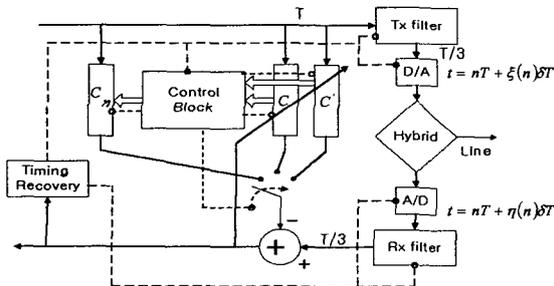
그림 1. 제안된 data-driven 반향 제거기 블록도
