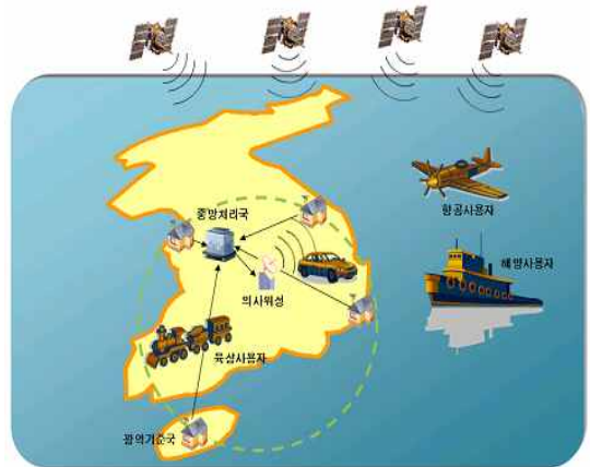
그림 1. 의사위성기반 광역보정시스템 개념도 Fig. 1. Pseudolite-based WADGNSS
