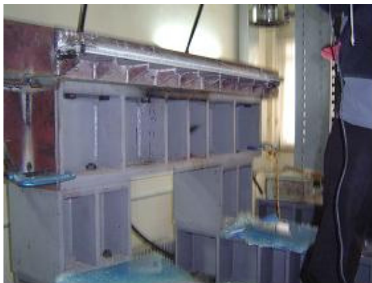
그림18. REC-P-C 시험체의 파괴전경
