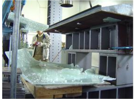
그림 15. REC-B-C 시험체의 파괴전경
