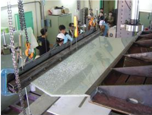
그림 13. REC-B-U 시험체의 파괴전경
