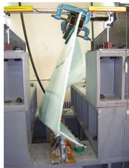
그림20. REC-P-CC 시험체의 파괴전경
