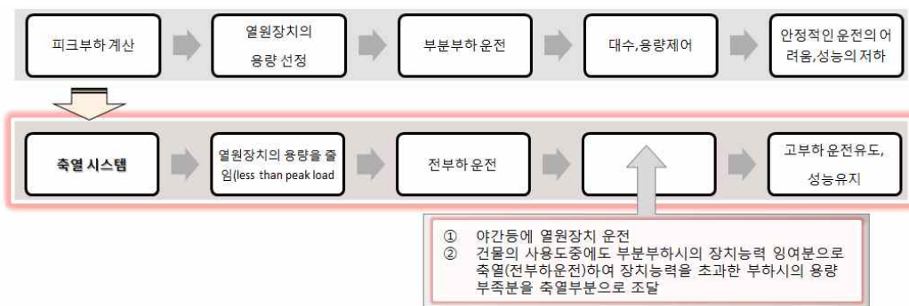
[그림 2.12] 축열 시스템과 비축열 시스템의 시스템 설계방법의 차이
