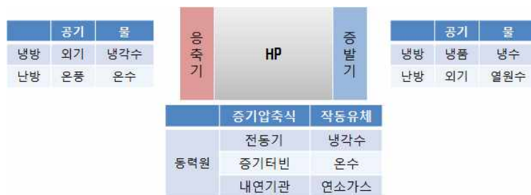
[그림 2.10] 히트펌프 시스템의 열원과 부하 및 동력원
