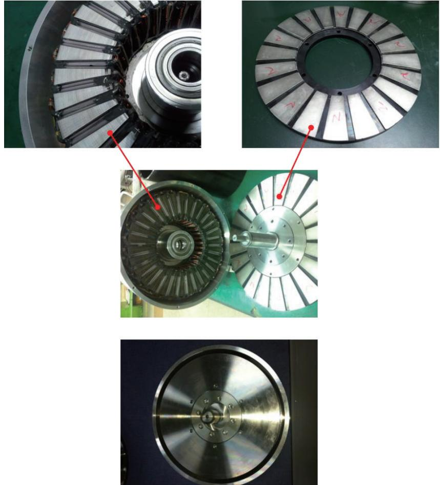
그림 4.4 고정자 및 회전자 체결 과정 [53]
