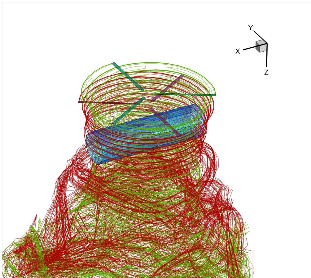
그림 3.3 동체효과를 고려한 동축반전 로터의 후류 형상
