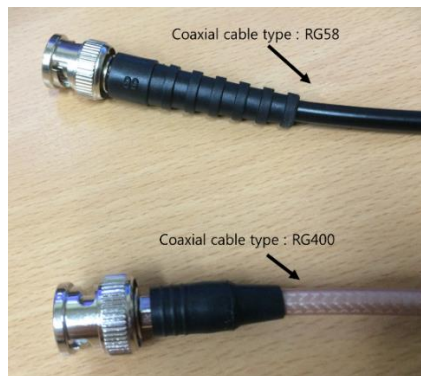
그림 4-14. CVR에 결합될 RG58, RG400 BNC 케이블
