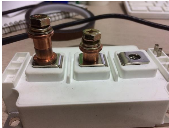
그림 4-51. Full SiC MOSFET 모듈과 DC단 기생 인덕턴스의 증가를 위해 8mm 구리 원기둥의 장착 모습(좌부터 2단, 1단, 0단)
