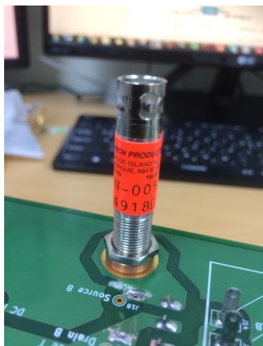
그림 4-13. 더블 펄스 실험 보드에 장착된 CVR 모습
