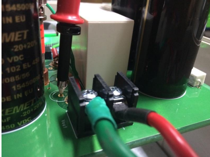
그림 4-8. 고전압 수동 프로브의 장착 모습
