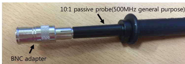
그림 4-15. CVR에 결합될 BNC 어댑터를 장착한 10:1 수동 프루브
