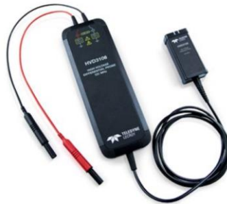
그림 4-4. 고전압 차동 프로브 HVD3106의 모습
