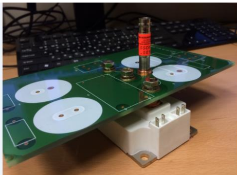
그림 4-28. 더블펄스 실험을 위한 실험 장치와 전압, 전류 측정 위치
