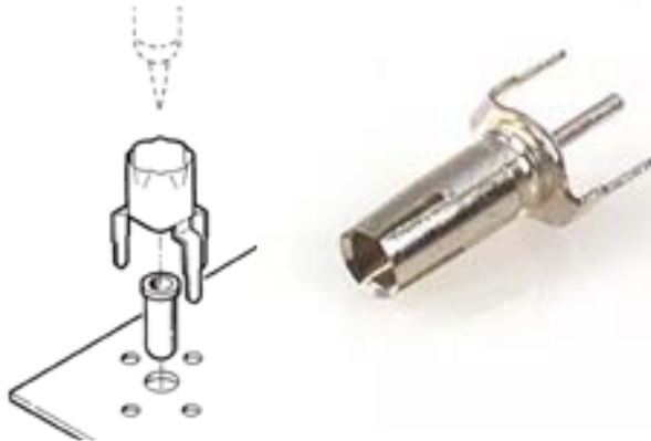
그림 4-9. 수동 프로브의 접지 리드 최소화를 위한 테스트 포인트 부품
