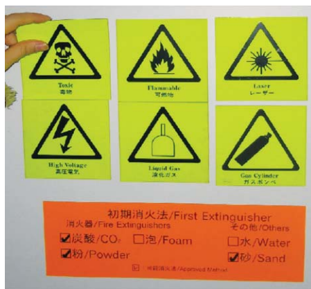
[그림 10] 리켄연구소 실험실 출입문에 부착된 위험물 표시 및 초기 소화 방법
