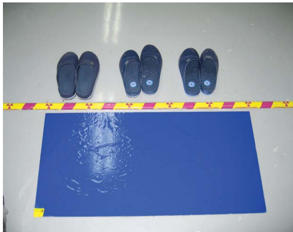
[그림 10] 개봉 RI실험실 설치된 방사능 오염방지 매트
