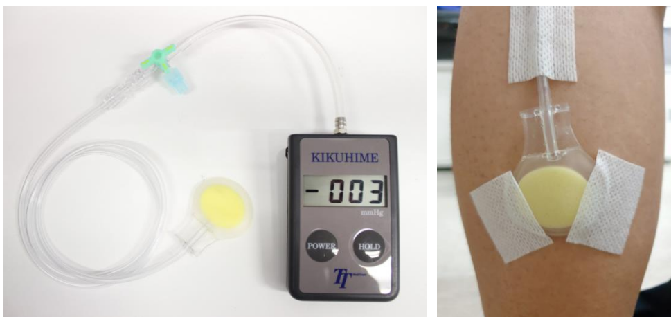
그림 33. Kikuhime를 이용한 의복압 측정
