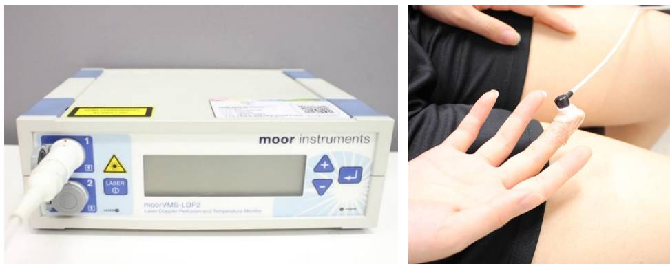
그림 37. moorVMS-LDF를 이용한 피부 혈류량 측정
