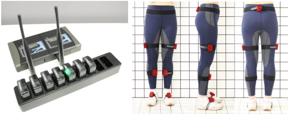
그림 38. 3차원 모션캡처 IMU 센서 myoMotion과 센서 부착 위치
