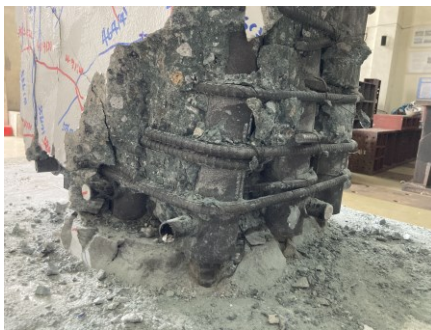
(d) Concrete cover removal after test
