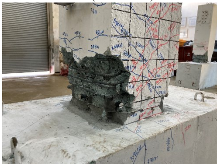
(d) Concrete cover removal after test
