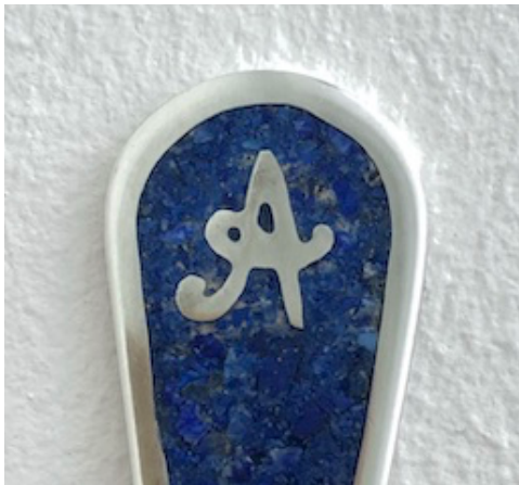
[그림 71] CA접착제를 사용하여 납작한 면을 상감했을 때 모습
