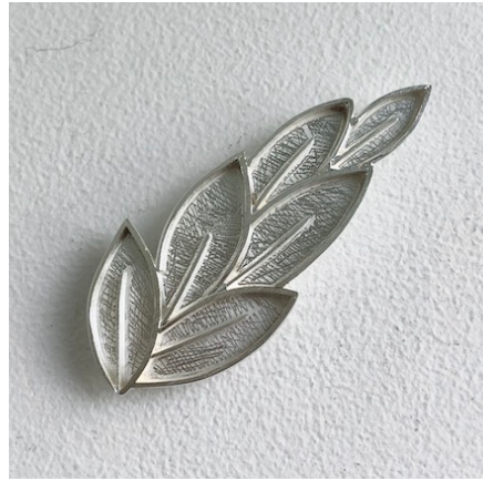
[그림 68] 조각정으로 표면처리한 모습
