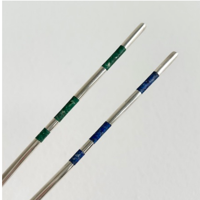
[그림 76] 원통형에 CA접착제와 자외선경화수지의 사용 비교
