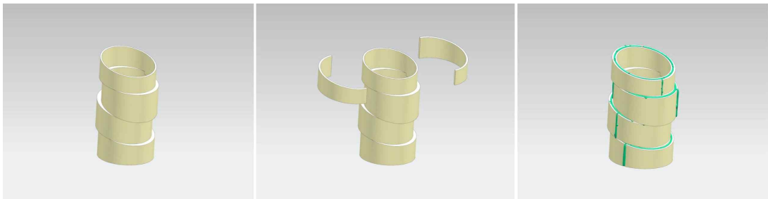
[그림 6-13] 3D 모델링을 통한 형상 검증 및 제작 과정 예시
