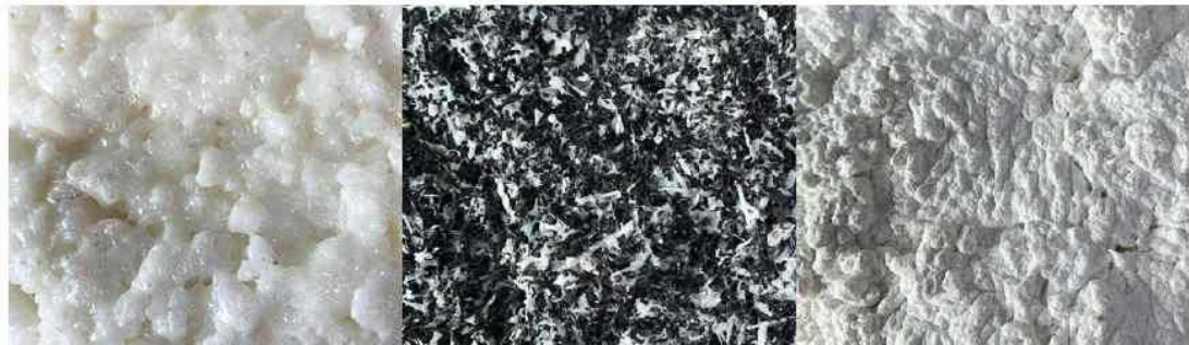
[그림 3-6] 일정 시간 공기 중에 노출되어 경화된 표면 질감
