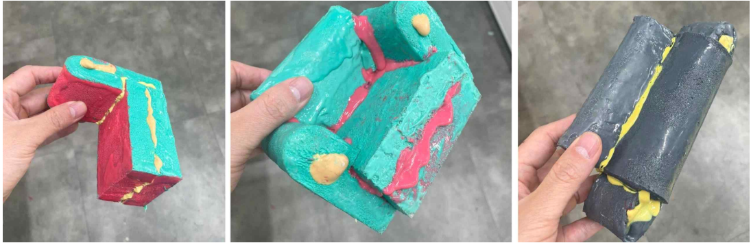
[그림 7-10] 스펀지의 휘어지는 특성을 활용한 프로토타입 실험 결과물
