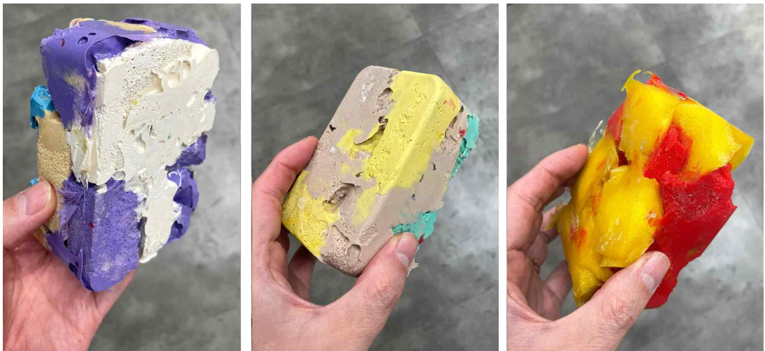
[그림 7-12] 금형 틀을 활용한 형태 및 질감 검증을 위한 프로토타입 실험 결과물
