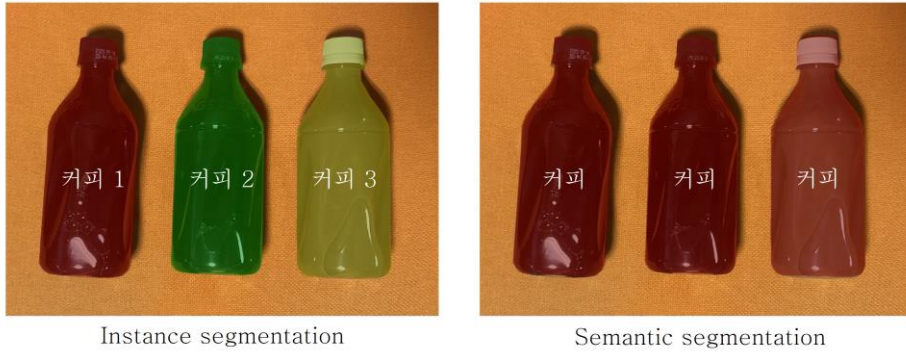
[그림 5] Instance segmentation과 semantic segmentation 대한 예시 이미지. Instance segmentation은 각기 다른 객체로 표현되는 반면에 semantic segmentation은 동일한 객체에 대해 하나의 mask로 표현됨.
