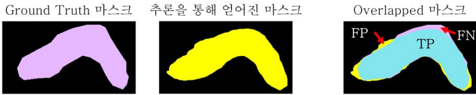
[그림 10] Dice similarity coefficient loss에서 TP (true positive), FP (false positive), 그리고 FN (false negative)이 의미하는 영역을 나타낸 그림. 보라색은 ground truth 마스크의 영역, 노란색은 추론을 통해 얻어진 마스크, 그리고 하늘색은 ground truth 마스크와 추론을 통해 얻어진 마스크가 겹치는 영역을 의미함.
