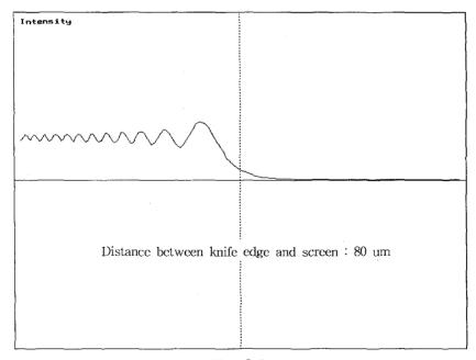
Fig. 2-3 Shadow Behind Knife Edge  $80\mu m$  Away
