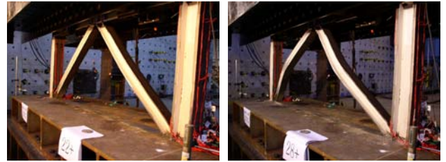
(a) \delta=30\text{mm} (b) \delta=60\text{mm} 그림 8. 변위별 1층 가새의 변형 형상 (CBF)
