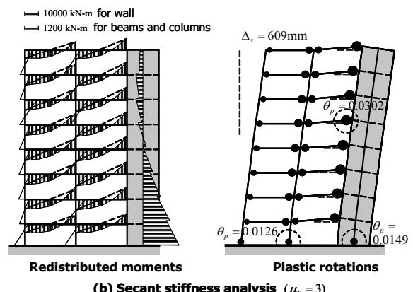
&lt;그림 8&gt; 할선강성해석을 이용한 이중골조의 내진설계
