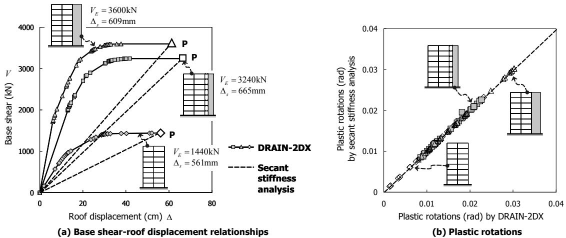
〈그림 10〉 할선강성해석을 이용한 내진설계 결과 검증
