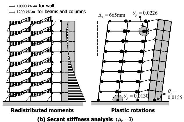
&lt;그림 7&gt; 할선강성해석을 이용한 모멘트골조와 전단벽이 링크보로 연결된 이중골조의 내진설계
