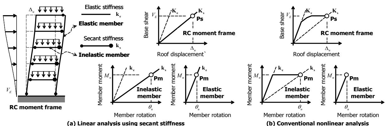
〈그림 1〉 할선강성해석을 이용한 설계개념
