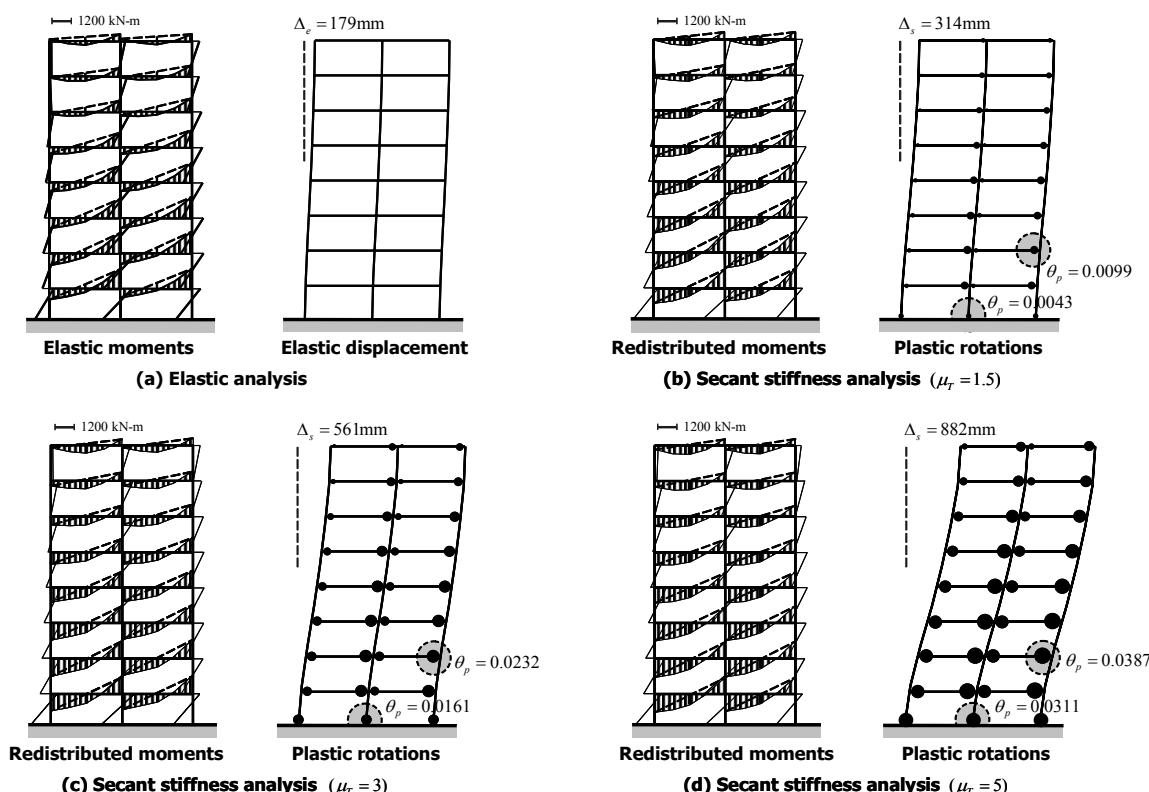
〈그림 6〉 할선강성해석을 이용한 모멘트골조의 내진설계
